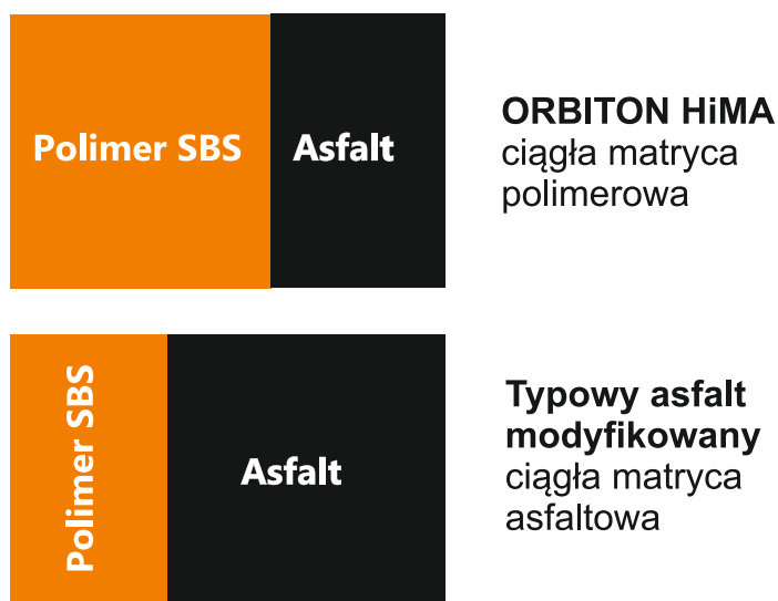
Rys. 1.1. Proporcje objętościowe między asfaltem a polimerem w typowym polimeroasfalcie i w asfalcie wysokomodyfikowanym
